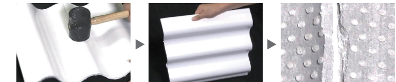
波形スレートの割れに塗膜が追従し、ひび割れの表面化を防ぐ
